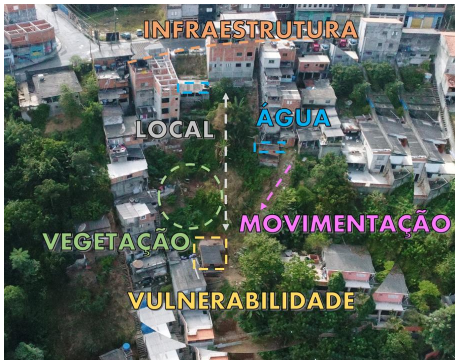
Elementos observáveis em campo para caracterização de um setor de risco. Fonte: LabGRis, 2020
