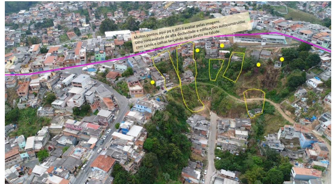
Foto oblíqua de Franco da Rocha, com pré-setorização e pontos críticos observados em escritório que permitem organizar roteiro de campo e otimizar a investigação em escala de detalhe. Fonte: LabGRis, 2020.
